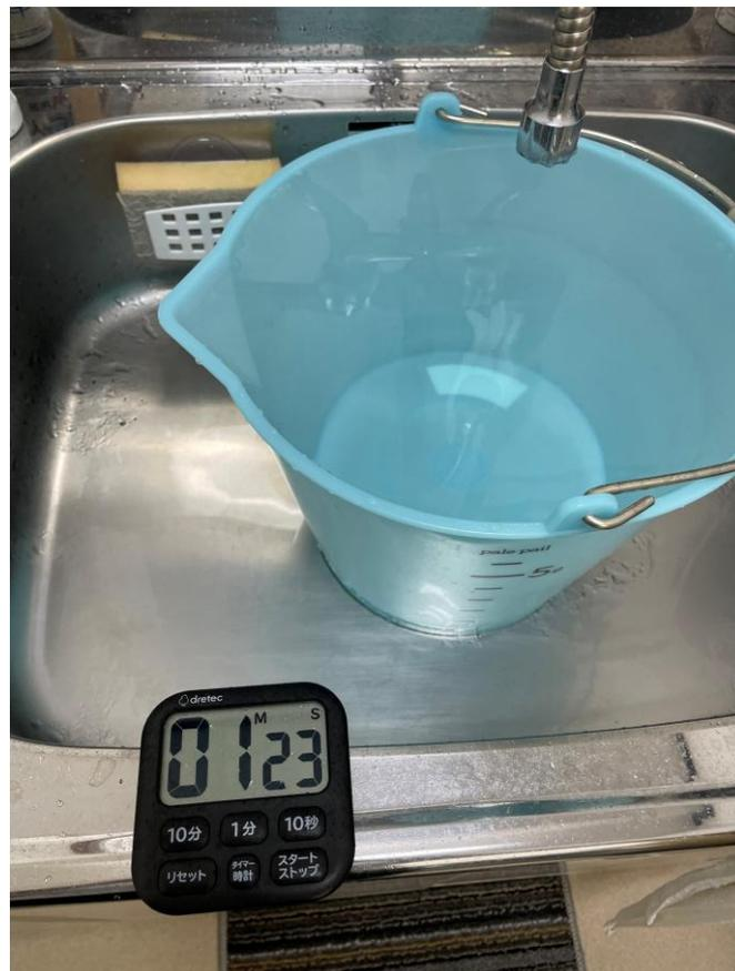
結果：当社製ナノバブルノズルを取り付けた場合、通常の蛇口の水量に比べ、約**73%**の節水量となった。
